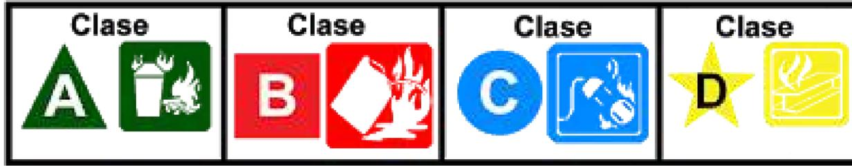
Los extintores de Polvo Químico Seco (ABC) son diseñados para proteger áreas que contienen riesgos de fuego Clase A (combustibles sólidos), Clase B (combustibles líquidos y gaseosos), Clase C (equipos eléctricos energizados) y Clase D (metales combustibles).
